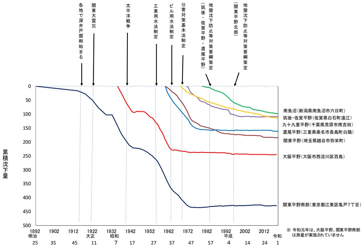
図9 代表的地域の地盤沈下の経年変化
