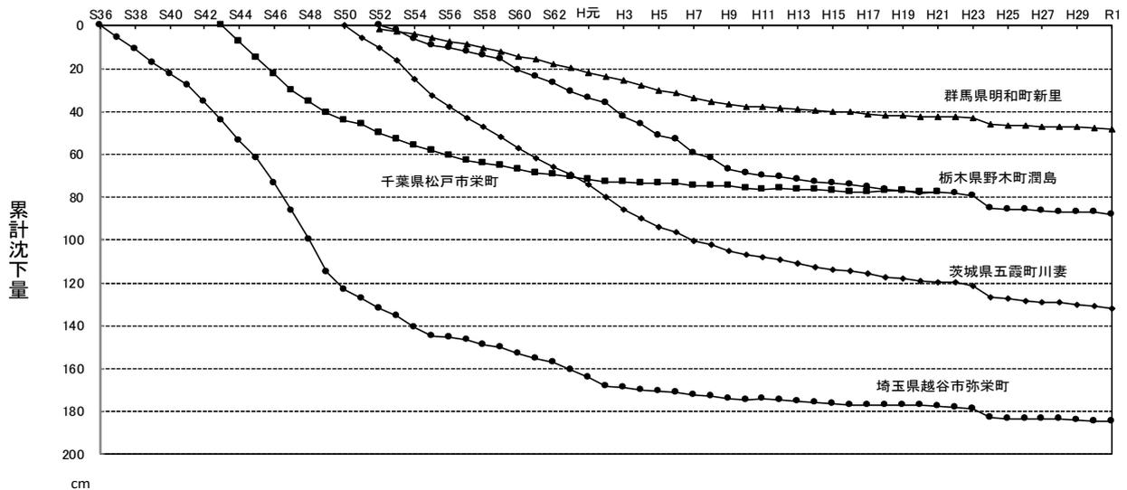
図 1.2 地盤沈下の経年変化
