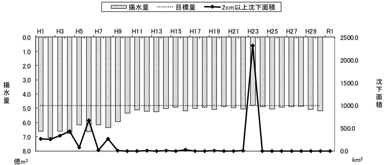
図 1.1 地下水揚水量及び地盤沈下面積の推移
