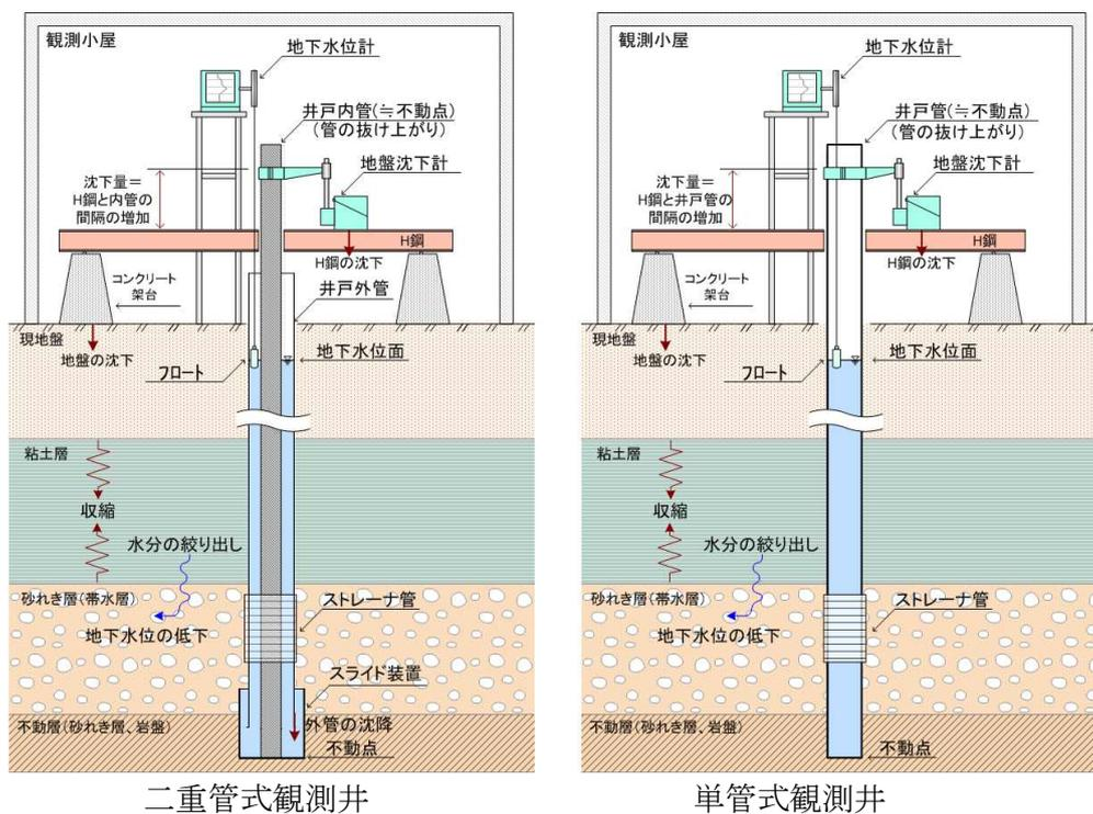
図 10 地盤沈下観測井の構造例
