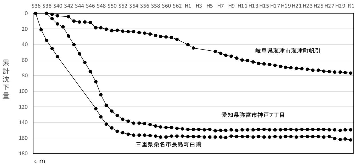
図 1 6 地盤沈下の経年変化
