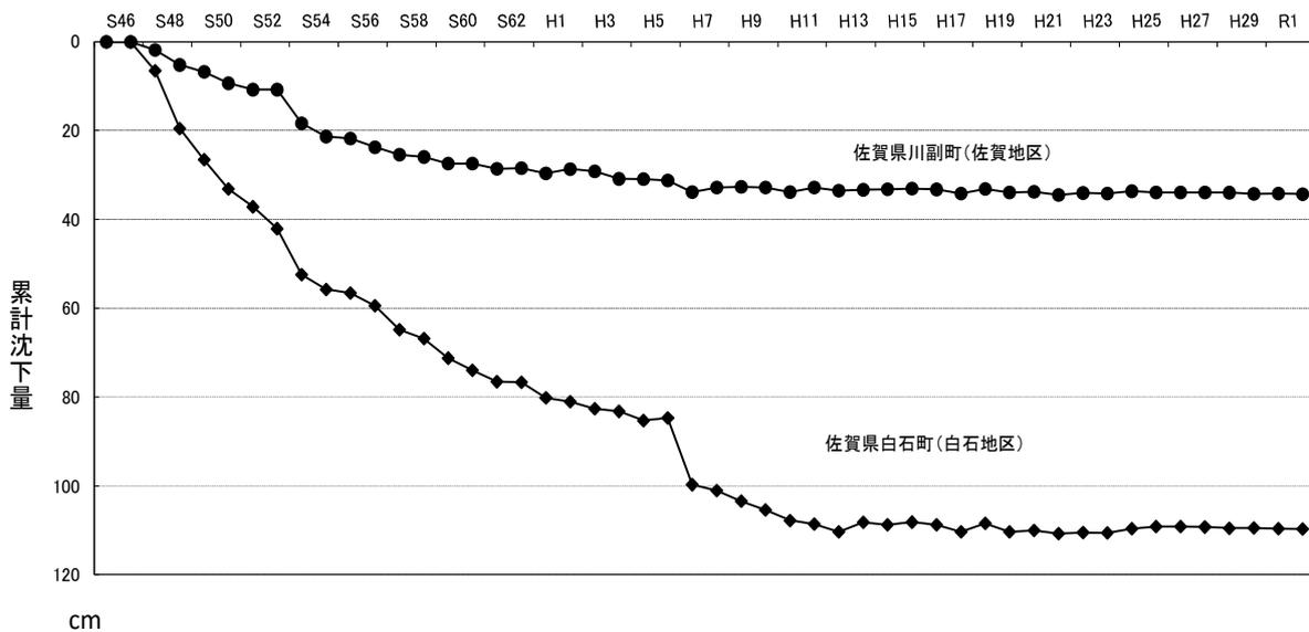
図 1 4 地盤沈下の経年変化
